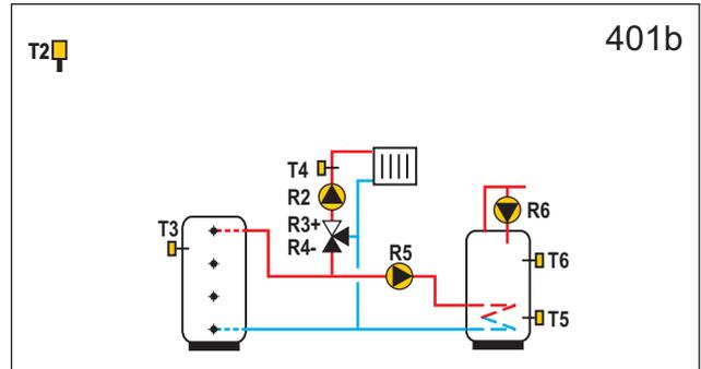
**WXD10B** Wärmespeicher, Mischerheizkreis, Brauchwassererwärmer.
