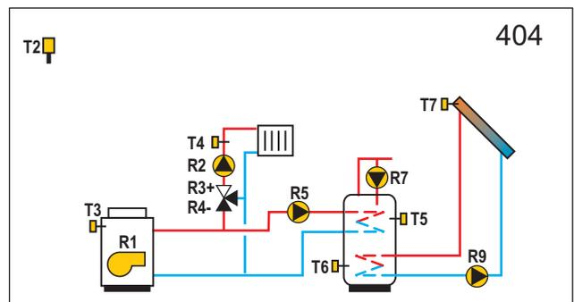
**WXD10** Ölkessel, Mischerheizkreis, Brauchwassererwärmer, Sonnenkollektoren.
