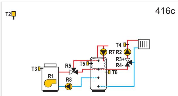
**WXD20** Wärmespeicher mit eingebautem, Ölkessel, Mischerheizkreis.
