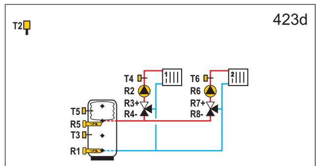
**WXD20** Wärmespeicher mit eingebautem Brauchwassererwärmer, Elektrik Nachwärmung, 2x Mischerheizkreis.
