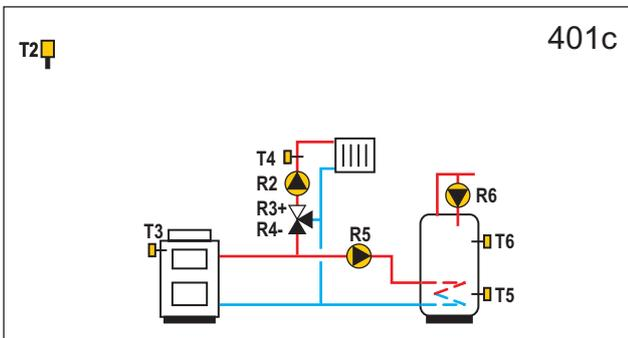
**WXD10B** Festbrennstoffkessel, Mischerheizkreis, Brauchwassererwärmer.
