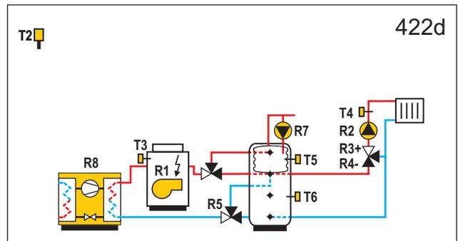
**WXD20** Wärmepumpe, Kombinierte Kessel auf Öl- und Elektrik, Wärmespeicher mit eingebautem Brauchwassererwärmer, Mischerheizkreis.
