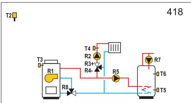
**WXD20** Kombinierte Kessel auf Öl- und Festbrennstoff, Mischerheizkreis, Brauchwassererwärmer.
