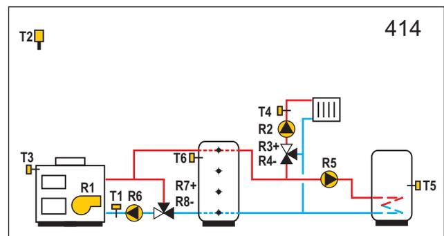
**WXD20** Kombinierte Kessel auf Öl- und Festbrennstoff, Wärmespeicher, Mischerheizkreis, Brauchwassererwärmer.
