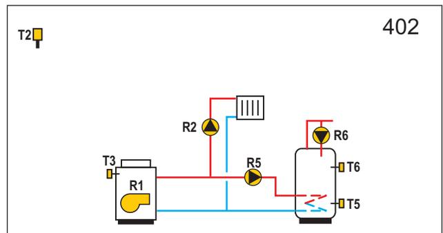
**WXD10B** Festbrennstoffkessel, Direktheizkreis, Brauchwassererwärmer.
