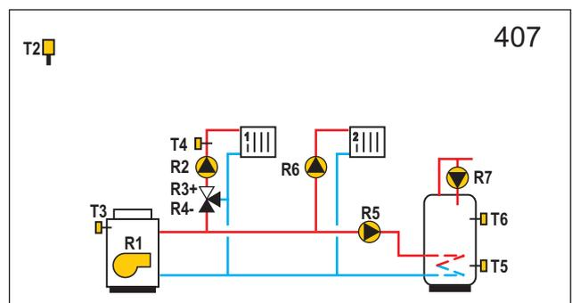
**WXD10** Ölkessel, Direktheizkreis, Mischerheizkreis, Brauchwassererwärmer.
