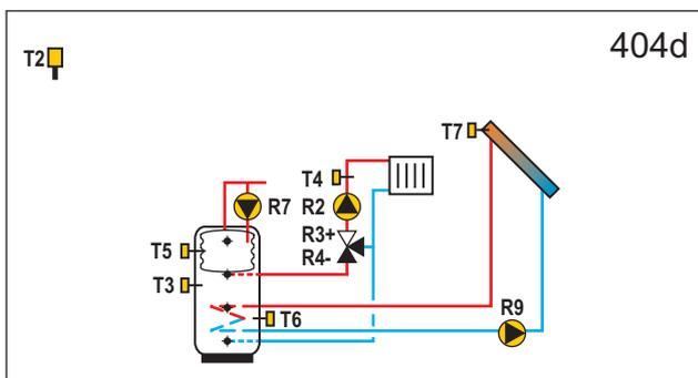
**WXD10** Wärmespeicher mit eingebautem Brauchwassererwärmer, Mischerheizkreis, Sonnenkollektoren.
