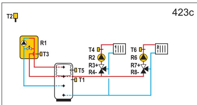
**WXD20** Gaskessel, Wärmespeicher mit eingebautem Brauchwassererwärmer, Kombinierte Kessel auf Öl- und Elektrik, 2x Mischerheizkreis.
