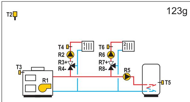
**WXD20** Kombinierte Kessel auf Öl- und Festbrennstoff, 2x Mischerheizkreis, Brauchwassererwärmer.
