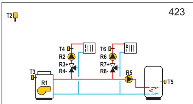
**WXD20** Ölkessel, 2x Mischerheizkreis, Brauchwassererwärmer.
