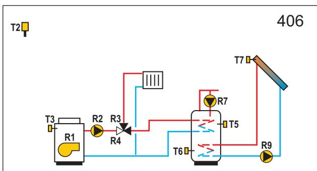
**WXD10** Ölkessel, Direktheizkreis, Brauchwassererwärmer, Sonnenkollektoren.
