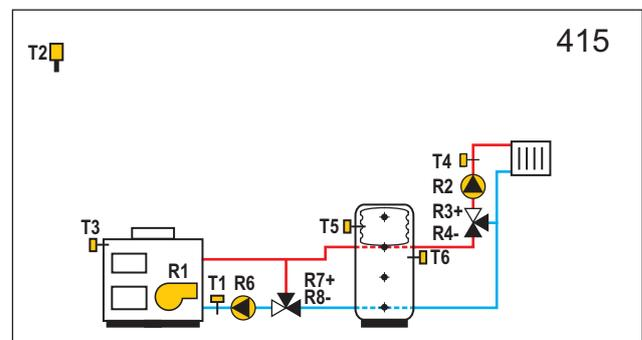
**WXD20** Kombinierte Kessel auf Öl- und Festbrennstoff, Wärmespeicher mit eingebautem, Mischerheizkreis.
