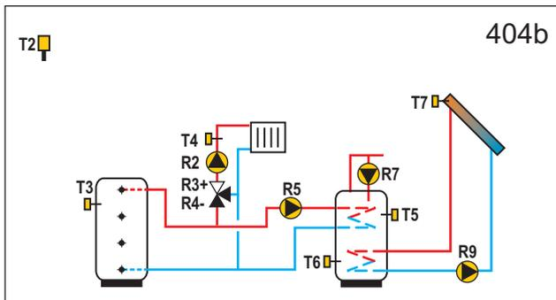
**WXD10** Wärmespeicher, Mischerheizkreis, Brauchwassererwärmer, Sonnenkollektoren.
