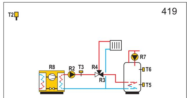
**WXD20** Wärmepumpe, Mischerheizkreis, Brauchwassererwärmer.
