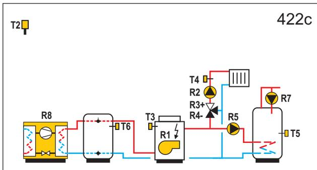
**WXD20** Wärmepumpe, Wärmespeicher, Kombinierte Kessel auf Öl- und Elektrik, Mischerheizkreis, Brauchwassererwärmer.
