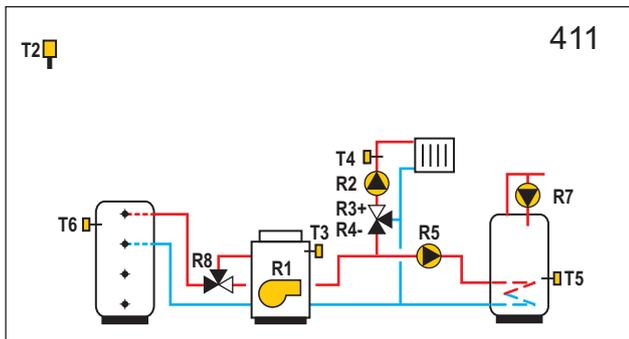
**WXD20** Wärmespeicher, Ölessel, Mischerheizkreis, Brauchwassererwärmer.
