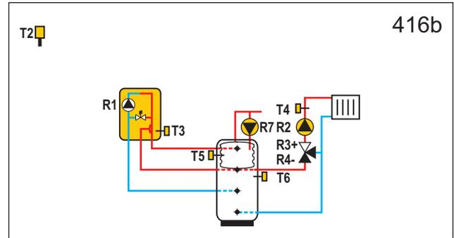
**WXD20** Gaskessel, Wärmespeicher mit eingebautem Brauchwassererwärmer, Mischerheizkreis.
