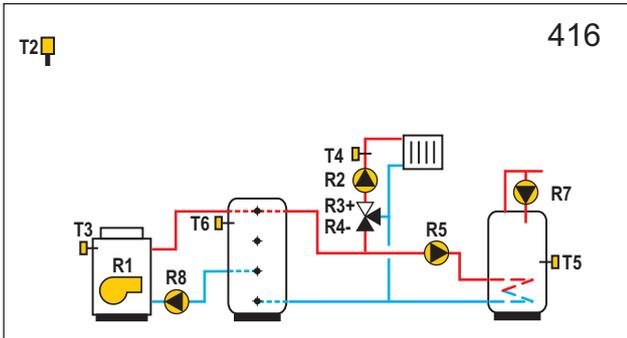
**WXD20** Ölkessel, Wärmespeicher, Mischerheizkreis, Brauchwassererwärmer.
