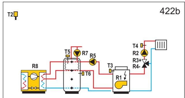
**WXD20** Wärmepumpe, Wärmespeicher mit eingebautem Brauchwassererwärmer, Kombinierte Kessel auf Öl- und Elektrik, Mischerheizkreis.
