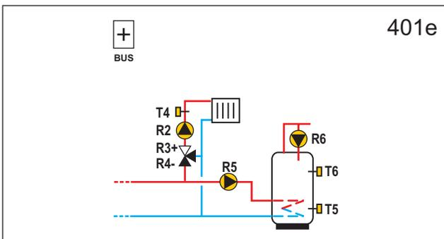
**WXD10B** System erweiterung - Mischerheizkreis, Brauchwassererwärmer.
