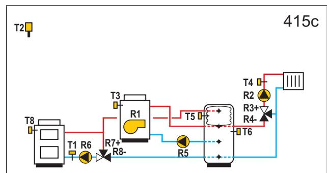
**WXD20** Festbrennstoffkessel, Ölkessel, Wärmespeicher mit eingebautem, Mischerheizkreis.
