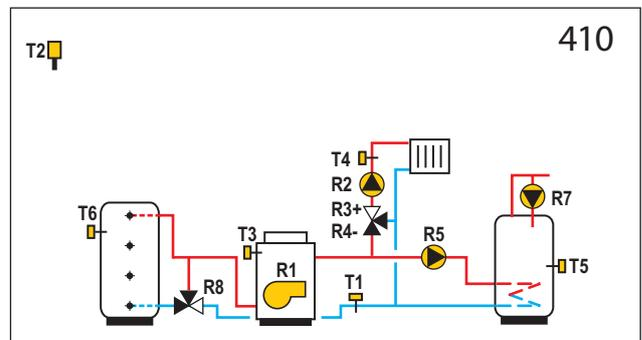
**WXD20** Wärmespeicher, Ölkessel, Mischerheizkreis, Brauchwassererwärmer.
