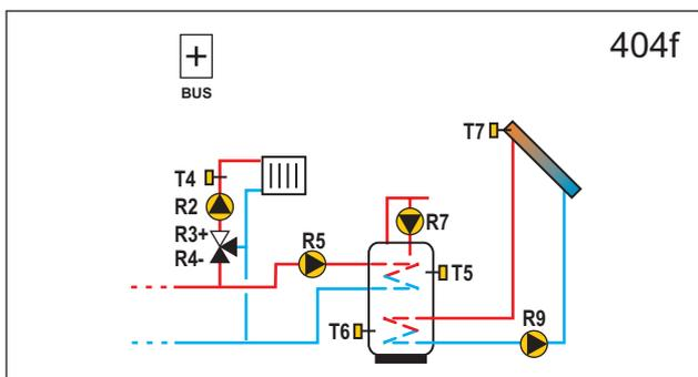
**WXD10** System erweiterung - Mischerheizkreis, Brauchwassererwärmer, Sonnenkollektoren.
