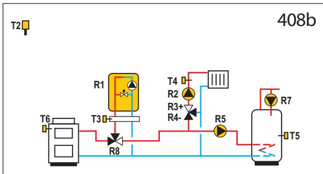
**WXD20** Festbrennstoffkessel, Gaskessel, Mischerheizkreis, Brauchwassererwärmer.
