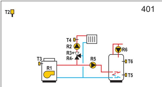
**WXD10B** Ölkessel, Mischerheizkreis, Brauchwassererwärmer.
