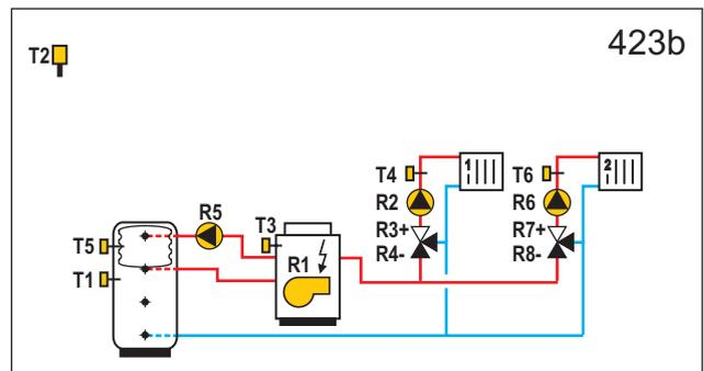
**WXD20** Wärmespeicher mit eingebautem Brauchwassererwärmer, Kombinierte Kessel auf Öl- und Elektrik, 2x Mischerheizkreis.
