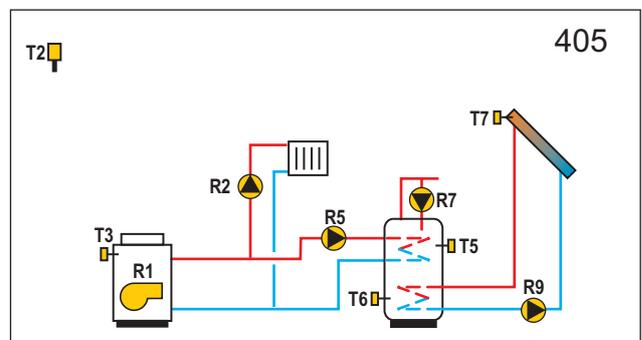
**WXD10** Ölkessel, Direktheizkreis, Brauchwassererwärmer, Sonnenkollektoren.
