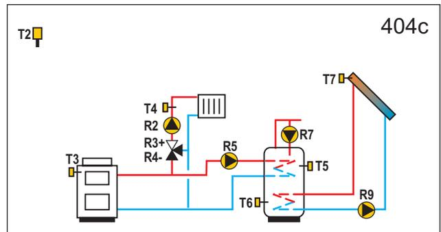
**WXD10** Festbrennstoffkessel, Mischerheizkreis, Brauchwassererwärmer, Sonnenkollektoren.
