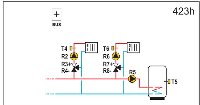
**WXD20** System erweiterung, 2x Mischerheizkreis, Brauchwassererwärmer.
