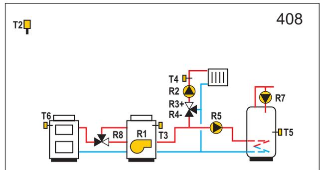
**WXD20** Festbrennstoffkessel, Ölkessel, Mischerheizkreis, Brauchwassererwärmer.
