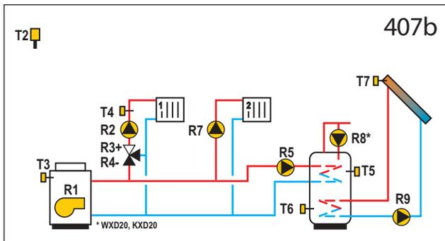
**WXD10** Ölkessel, Direktheizkreis, Mischerheizkreis, Brauchwassererwärmer, Sonnenkollektoren.
