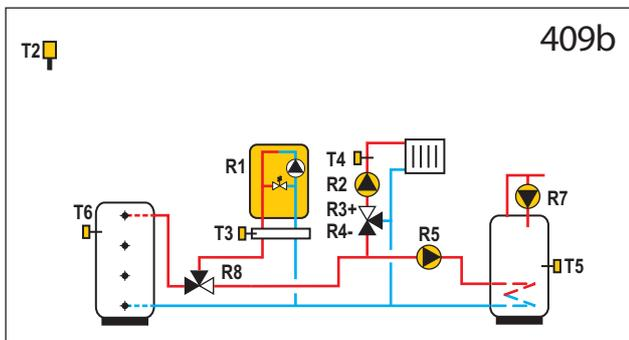
**WXD20** Wärmespeicher, Gaskessel, Mischerheizkreis, Brauchwassererwärmer.
