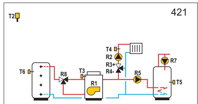
**WXD20** Wärmespeicher, Ölkessel, Mischerheizkreis, Brauchwassererwärmer.
