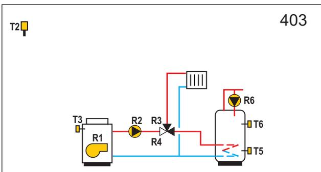
**WXD10B** Ölkessel, Direktheizkreis, Brauchwassererwärmer.
