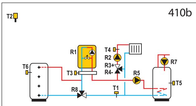
**WXD20** Wärmespeicher, Gaskessel, Mischerheizkreis, Brauchwassererwärmer.
