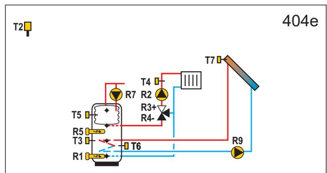
**WXD10** Wärmespeicher mit eingebautem Brauchwassererwärmer, Elektrische Nachwärmung, Mischerheizkreis, Sonnenkollektoren.
