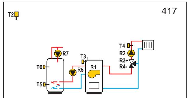
**WXD20** Brauchwassererwärmer, Kombinierte Kessel auf Öl- und Festbrennstoff, Mischerheizkreis.
