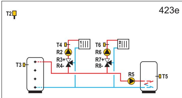
**WXD20** Wärmespeicher, 2x Mischerheizkreis, Brauchwassererwärmer.
