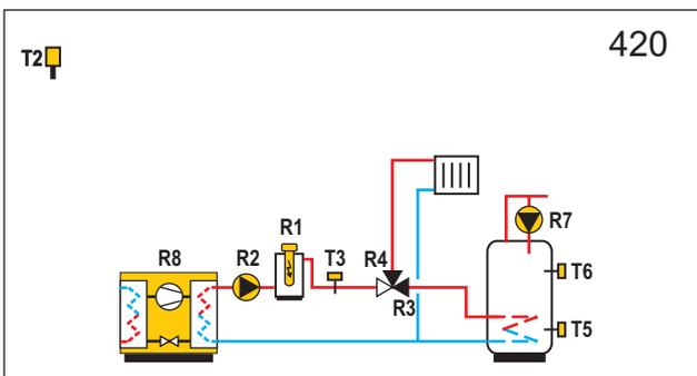
**WXD20** Wärmepumpe, NElektrische Nachwärmung, Mischerheizkreis, Brauchwassererwärmer.
