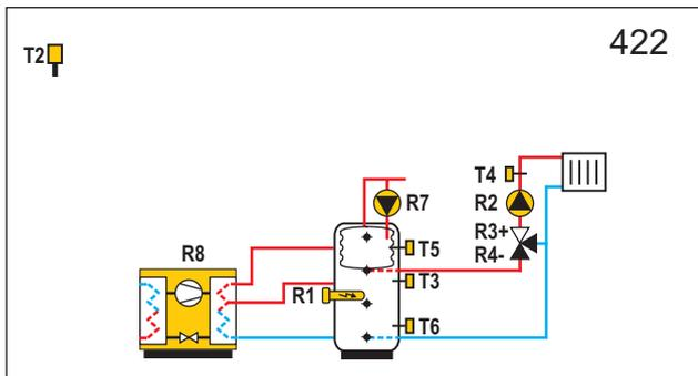
**WXD20** Wärmepumpe, Wärmespeicher mit eingebautem Brauchwassererwärmer, Mischerheizkreis.
