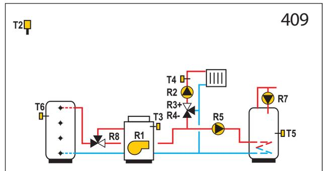
**WXD20** Wärmespeicher, Ölkessel, Mischerheizkreis, Brauchwassererwärmer.
