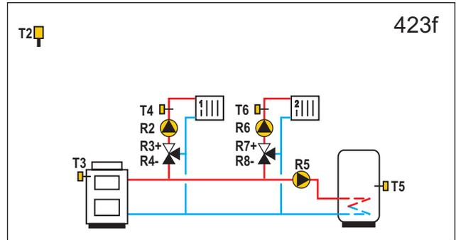
**WXD20** Festbrennstoffkessel, 2x Mischerheizkreis, Brauchwassererwärmer.
