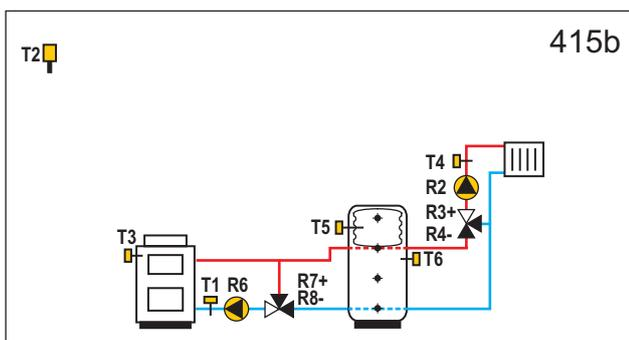
**WXD20** Festbrennstoffkessel, Wärmespeicher mit eingebautem Brauchwassererwärmer, Mischerheizkreis.
