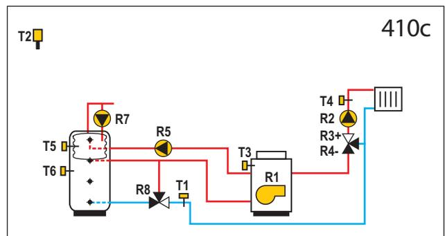
**WXD20** Wärmespeicher mit eingebautem Brauchwassererwärmer, Ölkessel, Mischerheizkreis.
