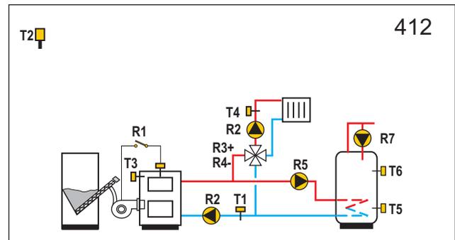
**WXD20** Pelletkessel, Mischerheizkreis, Brauchwassererwärmer
