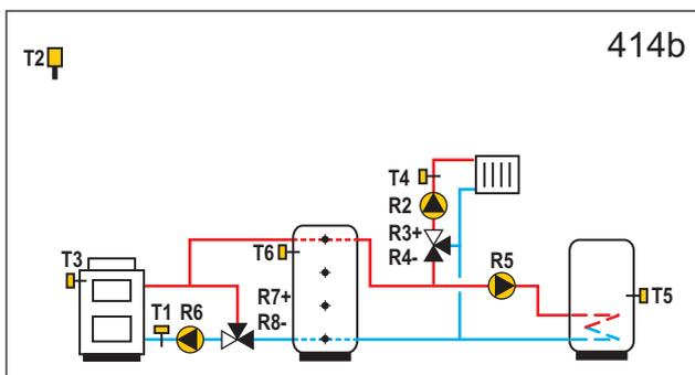
**WXD20** Festbrennstoffkessel, Wärmespeicher, Mischerheizkreis, Brauchwassererwärmer.
